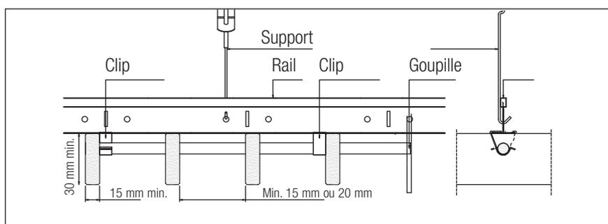
L'espacement des tourillons est de 300 mm. Les panneaux sont fixés les uns aux autres au moyen de tourillons mâles/femelles qui dissimulent les joints. Un joint creux de 10 mm est nécessaire entre deux panneaux sur sa longueur.
