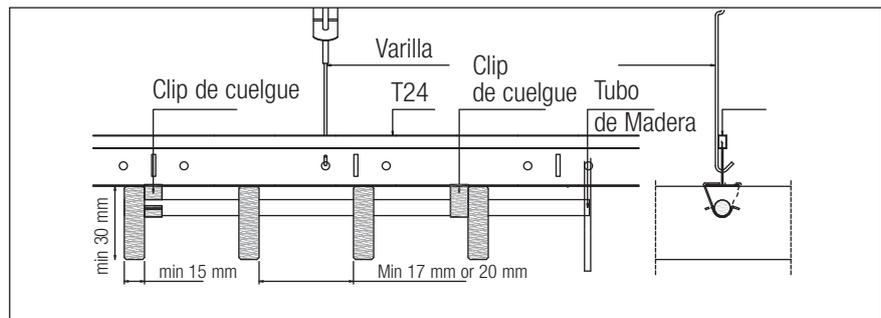
La distancia entre los tubos de madera es de 300 mm. Las parrillas en un sentido están conectadas entre sí de forma machihembrada manteniendo la separación entre listones y en el otro sentido presentan una separación de 10 mm.
