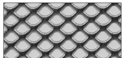
LS10 (Fe), freier Bereich: 57 %, Dicke: 2,0 mm, Abmessungen: 10 x 7,0 - 1,5 x 1,0 - 1,3 kg/m 2
